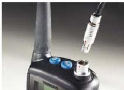
Connessione microfono stagno WPSM3 (opzionale)
