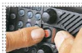
Controllo DSC dotato di protezione da colpi accidentali
